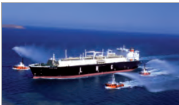
Méthanier de type membrane
